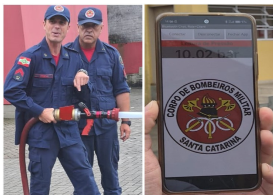
Figura 2 – Execução de testes pelo Sgt. Tonelli com o protótipo conectado entre esguicho e mangueira, leitura pelo aplicativo, informando a pressão em Bar lida no momento. Fonte: Autoria própria.
